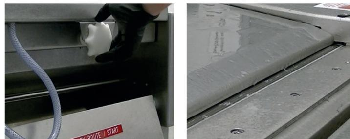
Commande à molette (à gauche) permettant de régler la table à petits filets (à droite)
